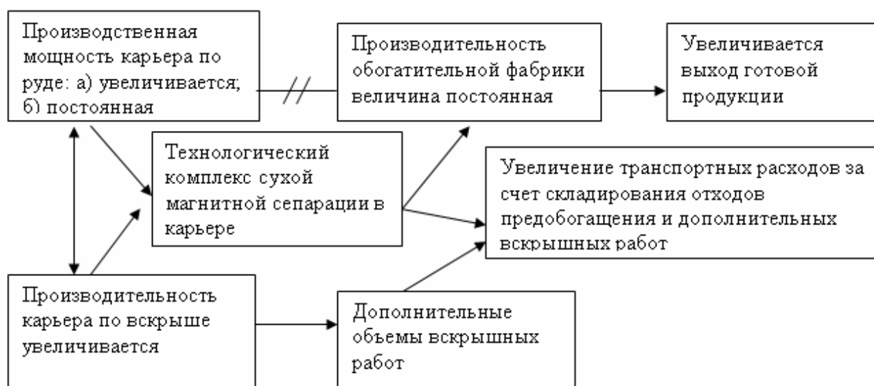
Рис. 5 – Схема развития предприятия при постоянной производительности обогатительной фабрики
